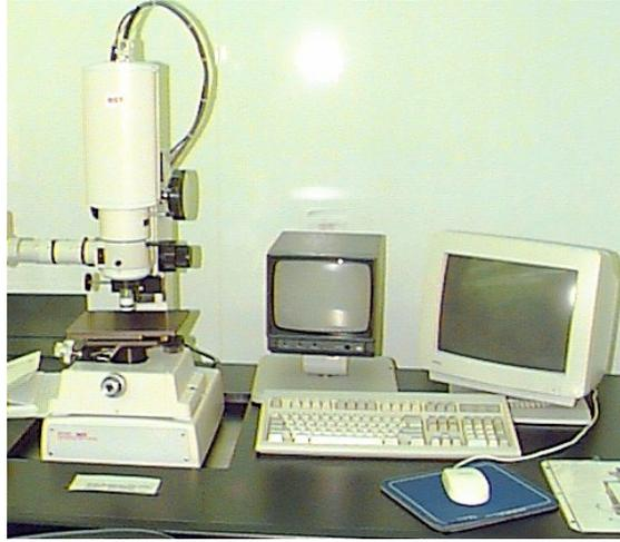
**Figura 3.5.** Perfilómetro Wyko topo 2D.
