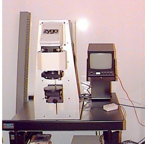
**Figura 3.4.** Perfilómetro heterodino Zygo 5500.
