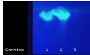
Fig. 1. Cromatografía en capa fina. Carril 1. Control de AFB<sub>1</sub> Cat. Sigma A-6636. Carril 2. Maíz inoculado con *A. parasiticus*; Carril 3. Maíz nixtamalizado.
