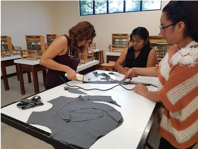
Fotografía 4. Cortadora de disco de una pulgada para el recortado de las prendas dependiendo el tipo de diseño de cada colección o material que el alumno utilice.
