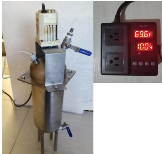
**Figura 2.** Sistema de extracción de biogás con agitación y control de temperatura.
