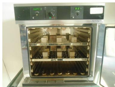
**Figura 5.** Secado inicial de las probetas
