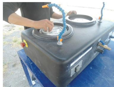
**Figura 3.** Pulido de una probeta
