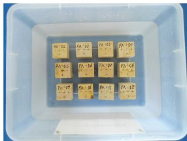
Figura 7. Probetas inmersas en agua destilada
