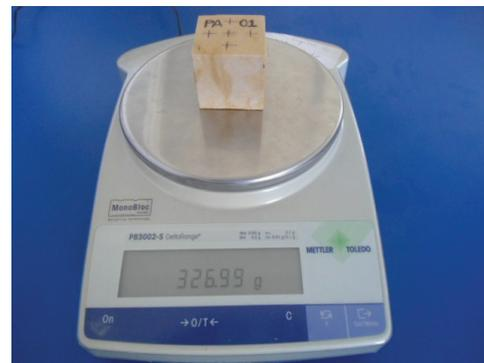
Figura 8. Peso saturado de la probeta PA01
