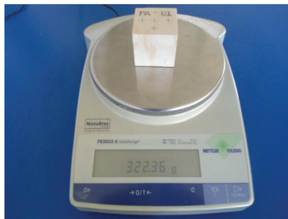
Figura 11. Peso seco final de la probeta PA01
