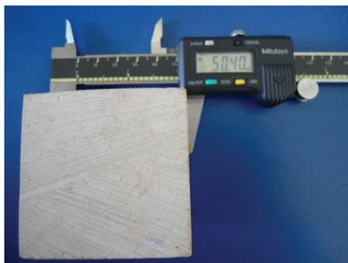
**Figura 2.** Medición en una cara de una probeta
