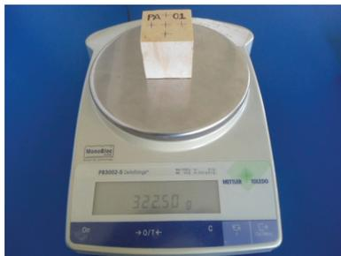
Figura 6. Peso seco inicial de la probeta PA01
